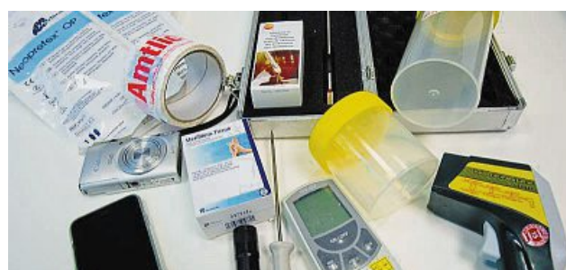
Kontroll-Ausrüstung: Probenbehälter, Messgeräte, Taschenlampe, Foto, Schutzkleidung, Absperrband.
